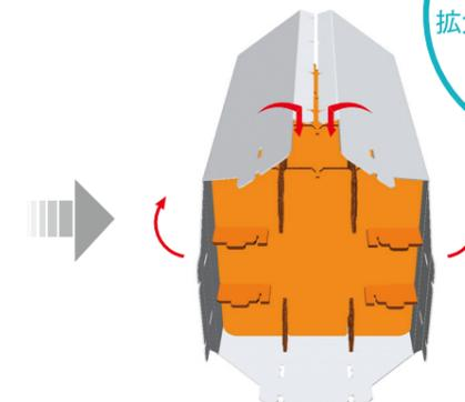
側板を上図のように中芯に巻きつけます。端同士のスリットをXのスリットに差し込みます。
