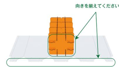
側板の上に組み上がった中芯をのせます。側板のスリットがある側と中芯の突起がある側が上になりますので揃えてください。
