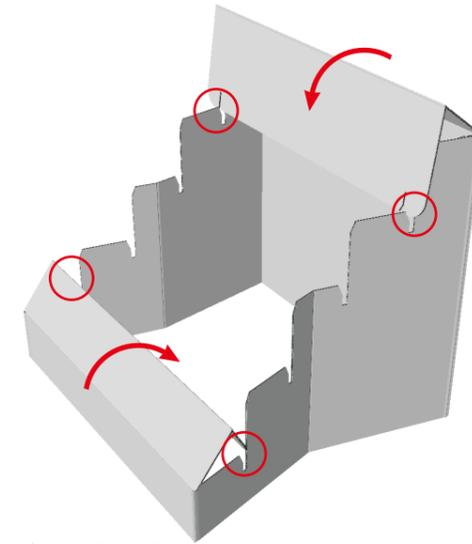
天板（フタ）の背の高い方から、閉じるように折り返し、先のスリットを胴体のスリットにしっかりと差し込みます。
